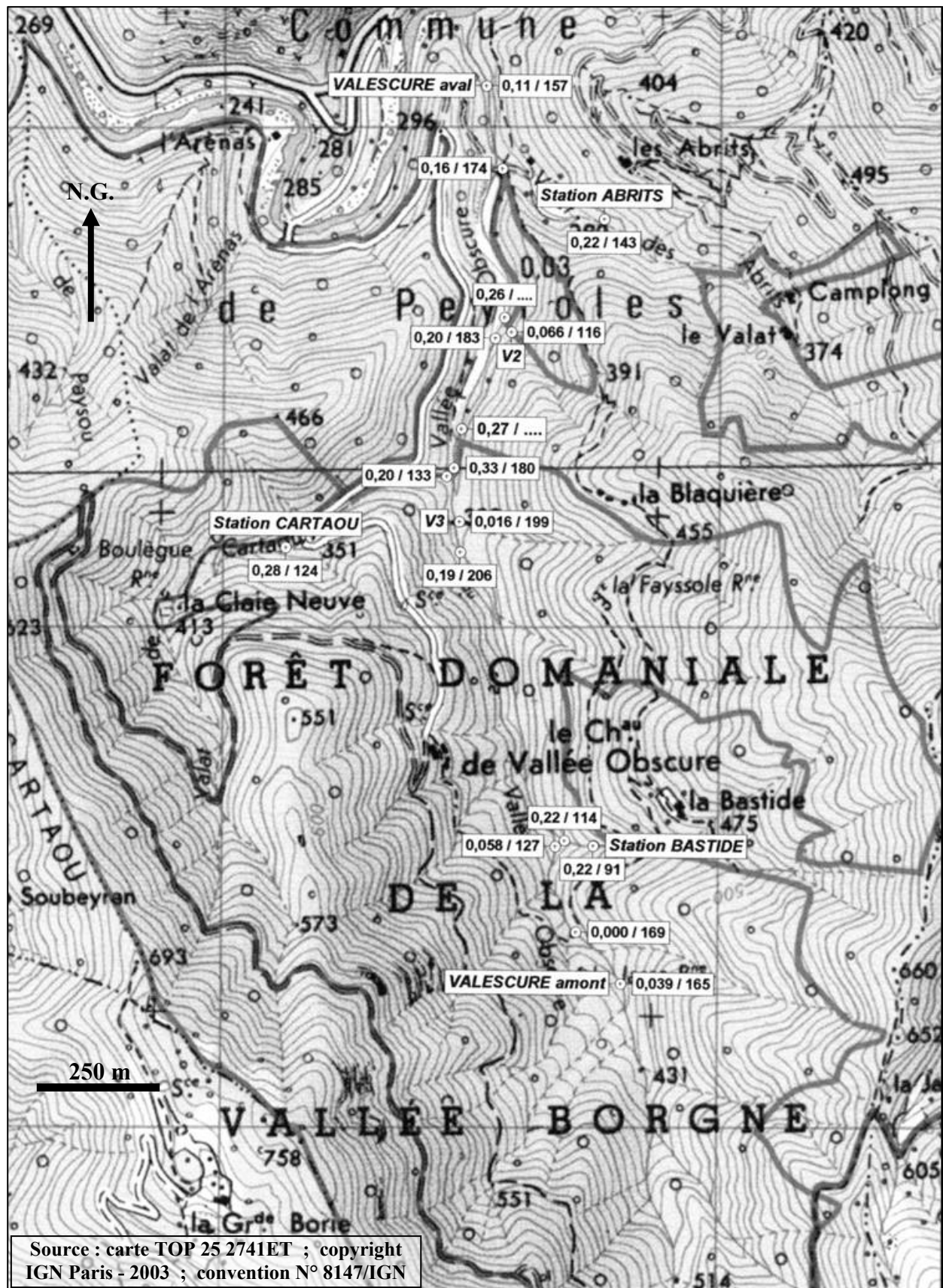
Fig. 7.3 - Campagne de jaugeages du 10 août 2005 (débit en l/s / conductivité en \mu\text{s}/\text{cm}/\text{cm}^2 ; .... : absence de mesure).
