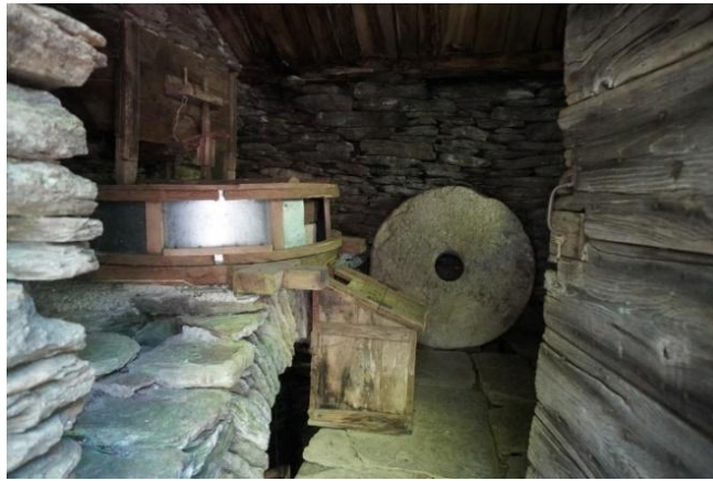
Photo 5 : intérieur du moulin permettant d'apprécier son mécanisme et la technique (source Errero, 2022)
