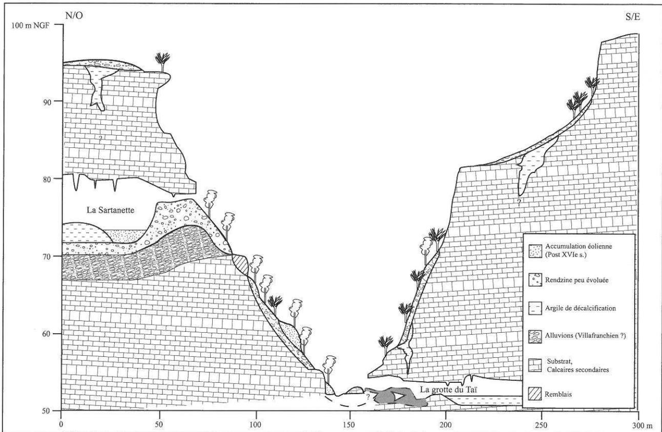
Fig. 2 : Coupe schématique des formations superficielles du vallon (D.A.O. B. Devillers).
